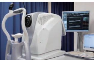
光の干渉現象を用いて、主に網膜の構造を検査する装置
