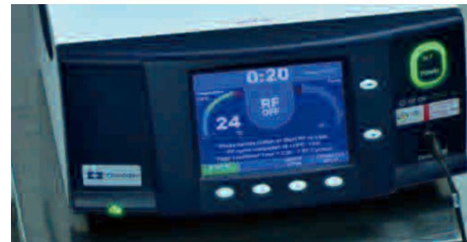
▲下肢静脈瘤血管内焼灼術に用いるラジオ波(高周波)装置
